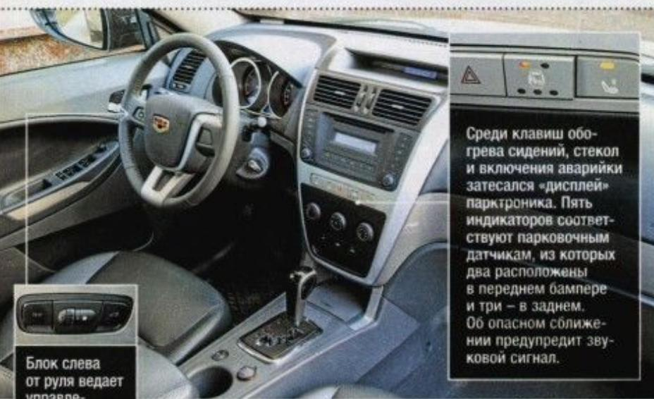
Блок слева от руля ведет управлением трил-компьютером, головным светом и открыванием двери багажника.
