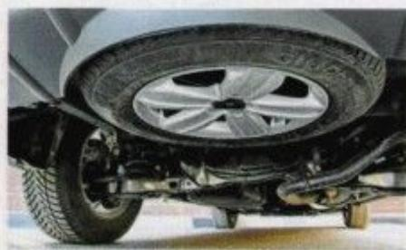
Полноразмерное запасное колесо спрятано под днищем.
