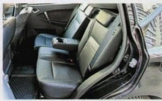
Задним пассажиром комфортинее всего. Раздельные части дивана сдвигаются вперед-назад и имеют регулируемые по углу наклона спинки.
